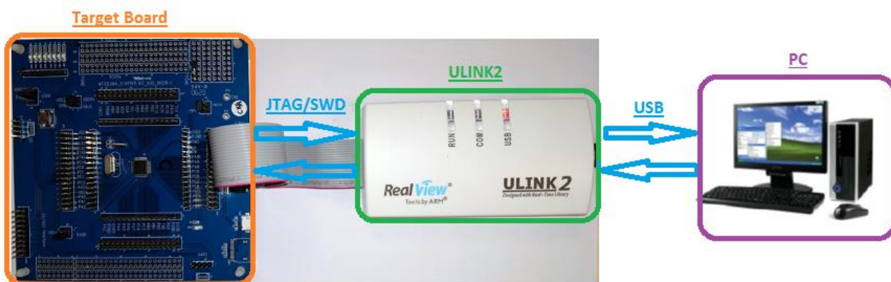
Figure 1-3 ULINK2 连接之示意图
