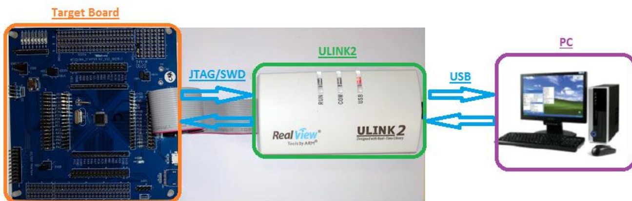
Figure 1-3 ULINK2 連接之示意圖
