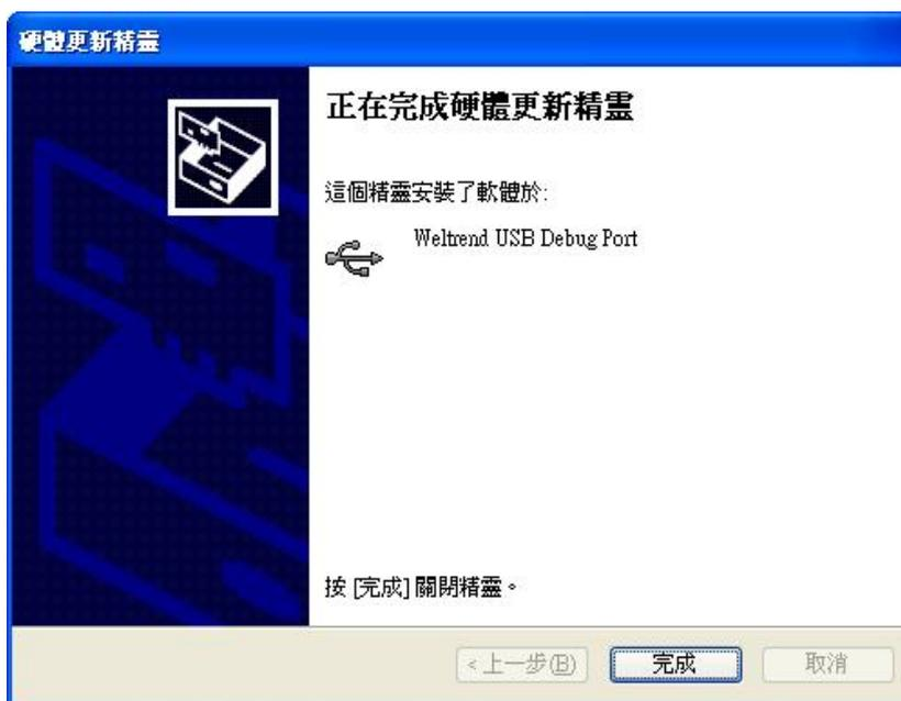
**【Step 8】** 安装完驱动程序之后，可以打开 PC 的装置管理员，可以看到此时多了『Weltrend USB Debug Port』就代表 WLINK-I<sup>2</sup>C Adapter 已安装完成。
